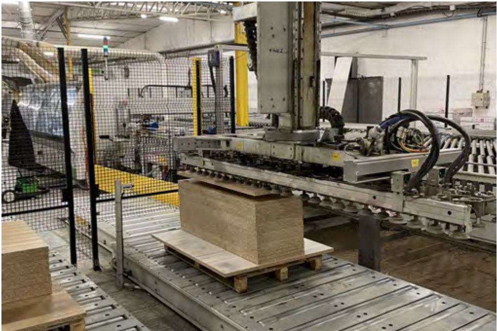
Automatisch laad/lossysteem van meubelpanelen voor de kantenlijmer.
