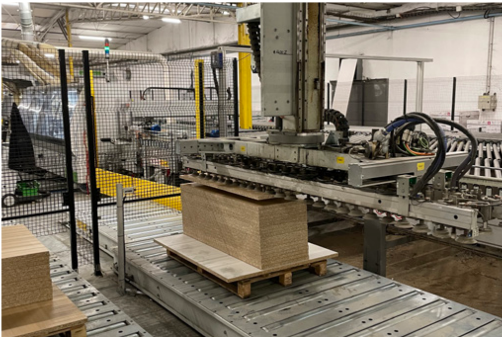
Système de chargement / déchargement automatique des plateaux sur la ligne de plaquage de chant.
