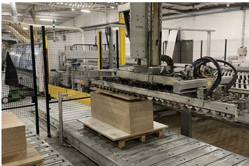
Automatisch laad/lossysteem van meubelpanelen voor de kantenlijmer.
